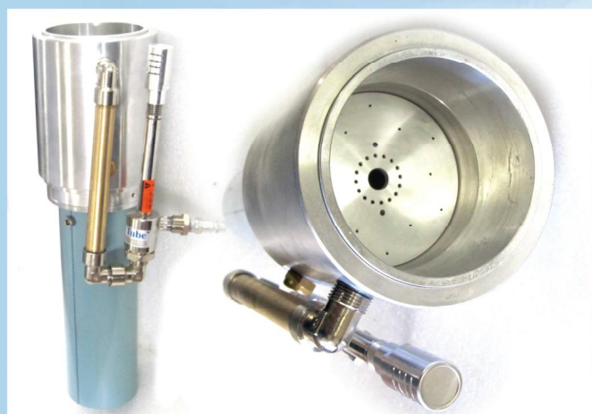
NUEVO SISTEMA EXTRA DE ENFRIAMIENTO con intercambiador de calor para uso prolongado de flama.
