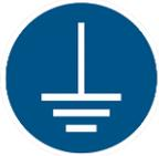
La máquina es capaz de descargar a tierra las cargas electrostáticas generadas durante las etapas de procesamiento. Sin embargo, no es posible determinar de antemano la capacidad de dispersión de las superficies sobre las que se pone la máquina. Será un deber del usuario asegurar la eficacia del sistema de puesta a tierra
