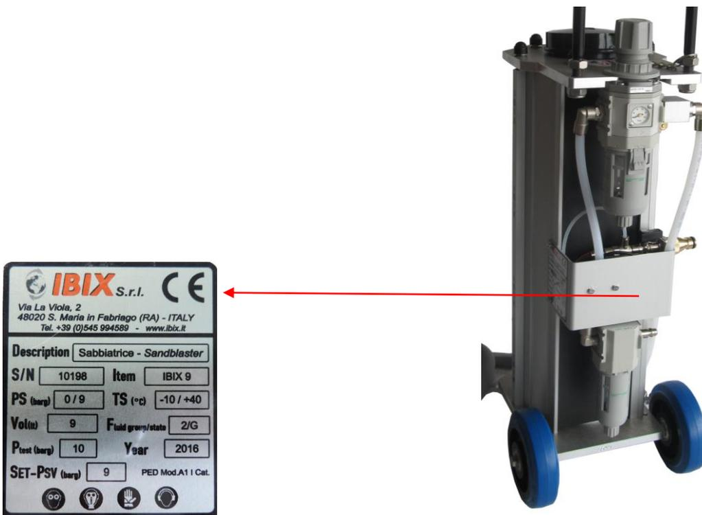
La figura muestra la ubicación y el aspecto visual de la placa de identificación de la máquina. Es necesario comunicar el número de matrícula cada vez que se toma contacto con la casa fabricante para solicitar informaciones o para efectuar el pedido de piezas de recambio.
